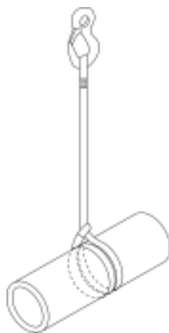
图 D.2 双匝扼圈连接
